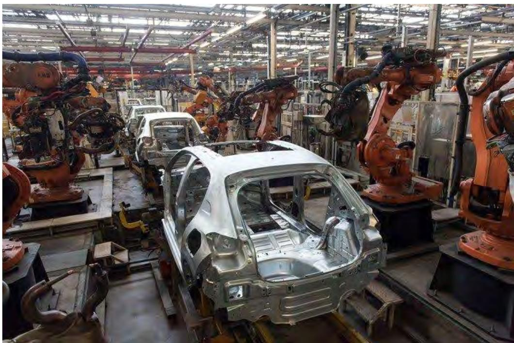
Se robotización algunos procesos en el armado de piezas y en la conformación de la carrocería.
